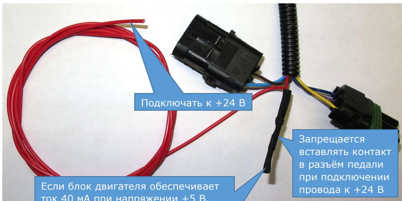
Если блок двигателя обеспечивает ток 40 мА при напряжении +5 В, снять изоляционный материал с контакта и произвести монтаж в разъем. Удлиняющий провод допускается обрезать либо заизолировать.
