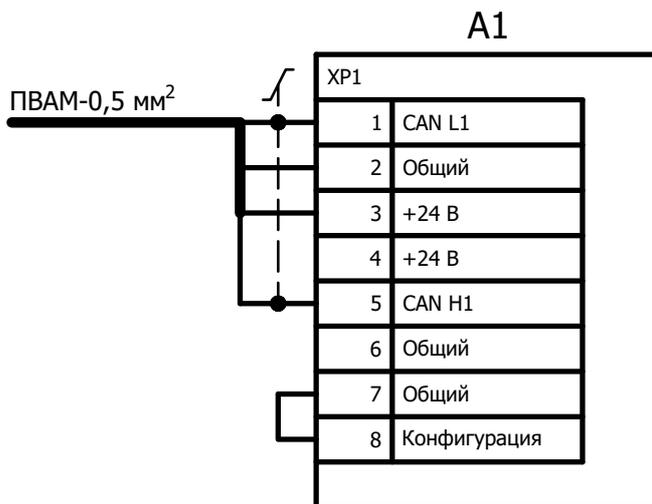
Ответные части разъёма XP1:
