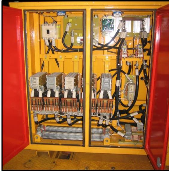
Серийный шкаф тягового электропривода включает в себя контакторные блоки, которые выполняют коммутацию обмоток возбуждения тяговых электрических машин за счет силы механического прижатия контактов.
