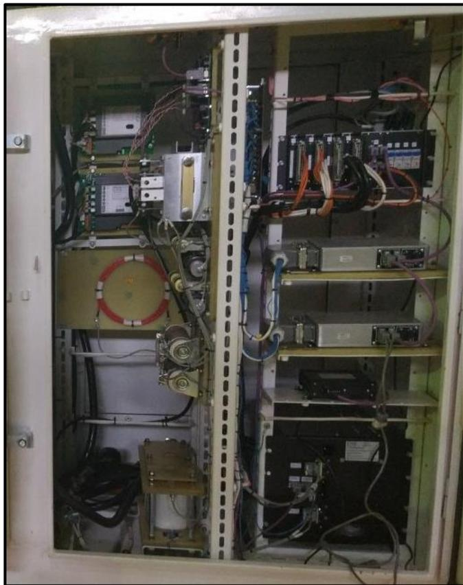
Новый бесконтакторный шкаф включает в себя тиристорные регуляторы, которые коммутируют обмотки возбуждения тяговых электрических машин за счет «мягкого» электронного управления.
