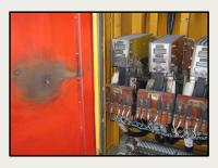
Серийный шкаф тягового электропривода включает в себя контакторные блоки, которые выполняют коммутацию обмоток возбуждения тяговых электрических машин за счет силы механического прижатия контактов.
