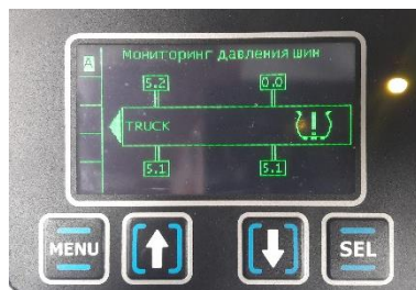
Диагностика критически низкого давления шины
